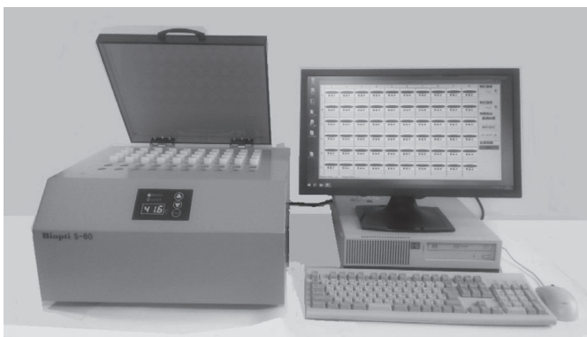
写真3 ダーラム管自動検出装置「Biopti S-60」
