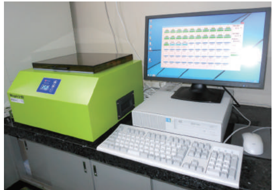
新宿高野・府中工場の品質管理室に設置された大腸菌群の自動検出装置「バイオプティ」。1回の検査で最大60検体を処理できる（協和医療器ではバイオプティをメンテナンス付きでレンタルしている）。
